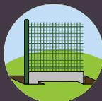
1. Après avoir placé un cordeau, creuser des trous de 40 cm de diamètre et de 50 cm de profondeur reliés par des tranchées (dimensions à définir suivant les plaques)
