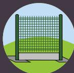
3. Positionner la première plaque de soubassement ainsi que le panneau rigide dans la feuillure du poteau. Placer les clips pour stabiliser le tout
