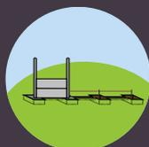
3. Positionner les 2 premières plaques dans la rainure du poteau (laisser un jeu de 5 mm dans la feuillure) et vérifier le niveau
