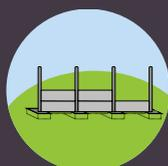
4. Sceller le deuxième poteau en vérifiant le niveau. Ajuster la hauteur et la verticalité du poteau. Répéter les opérations et mettre en place les autres plaques après séchage
