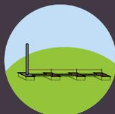
2. Sceller le premier poteau avec du mortier béton. Ajuster la hauteur et la verticalité
